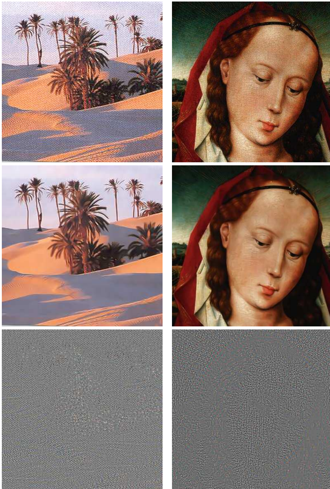
FIG. D.2: Restauration d'images couleur. Dans la première colonne, nous avons éliminé un effet de "scan" dont la texture est visible sur l'image de différence présentée en bas. La deuxième colonne contient la "restauration" d'un tableau. L'image de différence affichée à la dernière ligne révèle les craquelures de la peinture.
