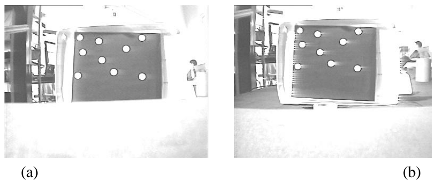
FIG. 32 – Image transmise par la caméra : (a) distorsion, (b) bruit lié à la transmission
