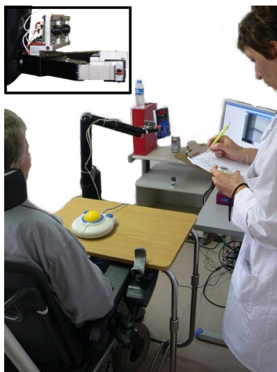
FIG. 1.23 – Aviso en cours d'évaluation au centre de Garches. Aviso est un bras MANUS équipé d'un banc de stéréovision et d'une interface homme machine intuitive
