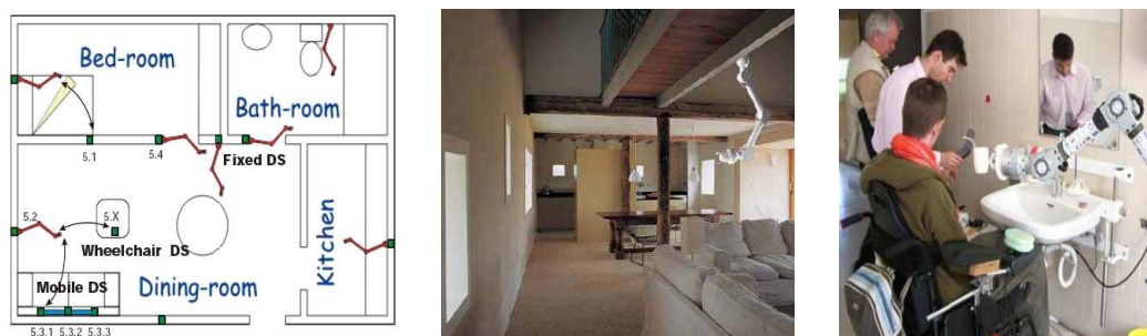
FIG. 1.13 – Le robot Mats peut se déplacer de prise en prise à l'intérieur d'une maison, se fixer sur un support fixe ou encore sur un fauteuil roulant
