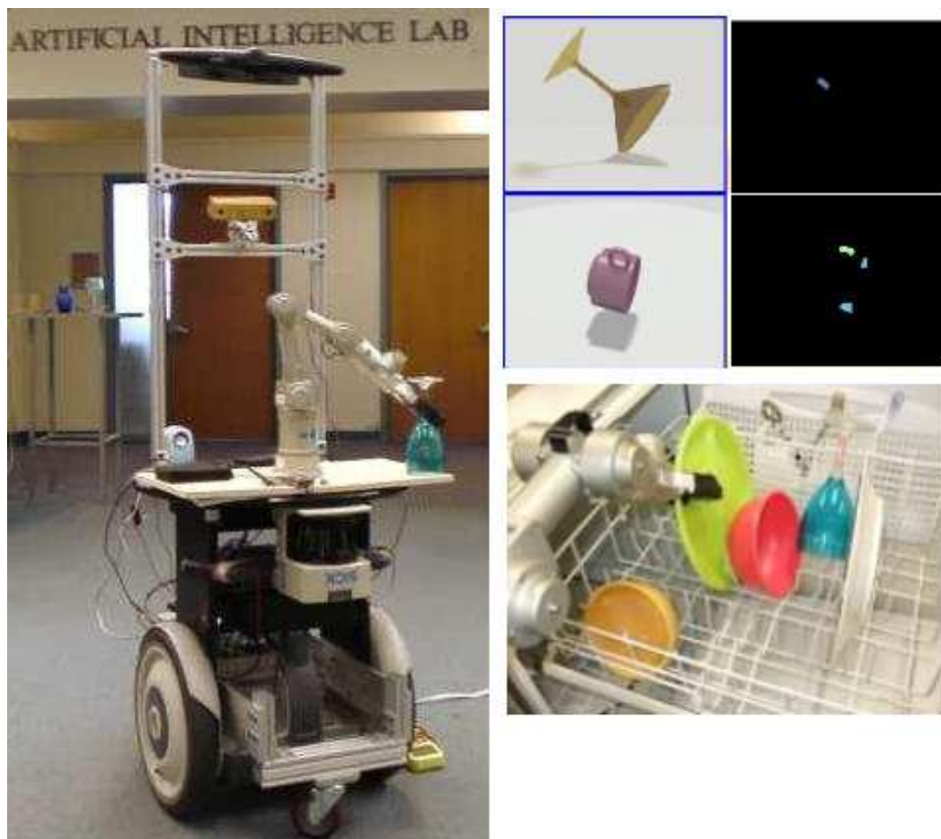
FIG. 1.19 – Le détecteur de points de saisie est entraîné sur des données simulées. Il est équipé d'une caméra qui lui permet de retrouver ces points de saisie sur les images courantes. Le système saisit ensuite les objets en boucle ouverte [Saxena 08].
